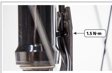
3. Überprüfen Sie den Bremserschlauch und achten Sie darauf, dass er nicht mit dem unteren Bein der Lefty, der Bremsscheibe oder den Speichen in Berührung kommt.
