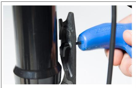
2. Führen Sie den Bremserschlauch durch den Kanal oben im GuideGuard. Drehen Sie die Schlauchklemme so, dass sie den Bremserschlauch bedeckt. Ziehen Sie die Schlauchklemme mit einem 2,5-mm-Inbusschlüssel auf 1,5 Nm an.
